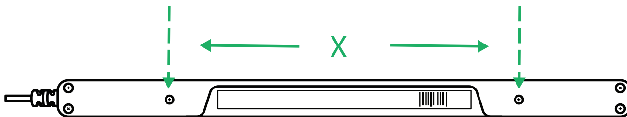
Figure 4.1 Razdaljina od centra jednog M3 šrafa do drugog
