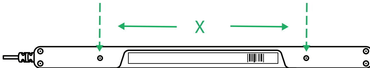
Obrázok 4.1 Vzďialenosť C-C medzi skrutkami M3
