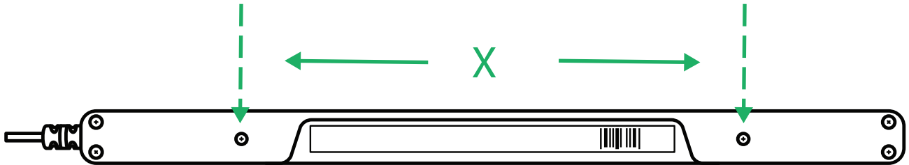
Εικόνα 4.1 Απόσταση C-C μεταξύ των βιδών M3
