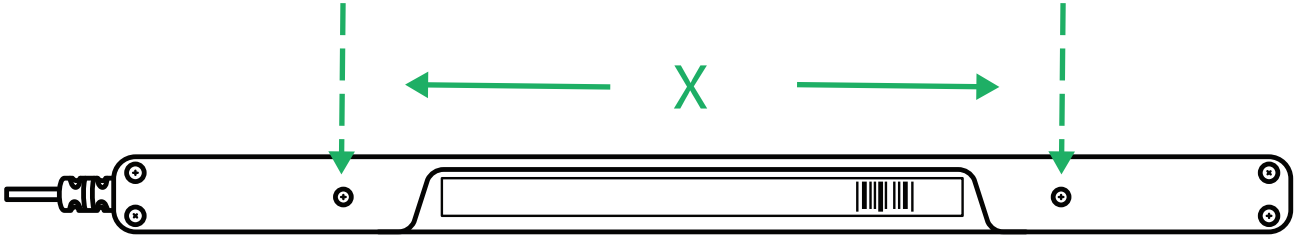
الشكل 4.1 المسافة من المركز إلى المركز بين مسامير M3
