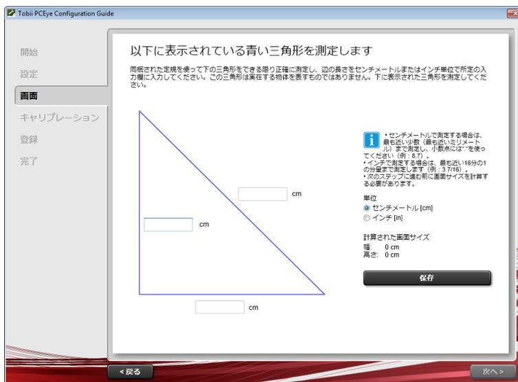
画面ページでは、画面上の三角形を形成する青い線を、同梱された PCEye Mini の取り付けガイドの側面にある目盛りを使って計測し、その値を所定欄に入力します。続いて保存を選択します。
