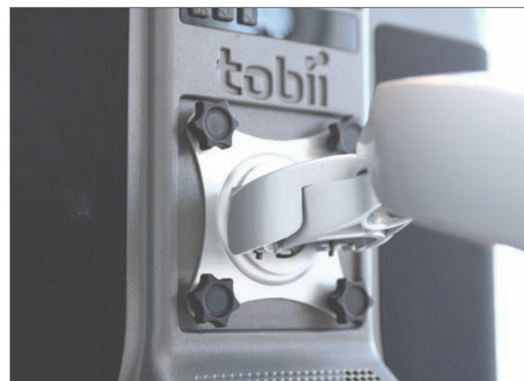
Bild 5: VESA montering av monitorarm
