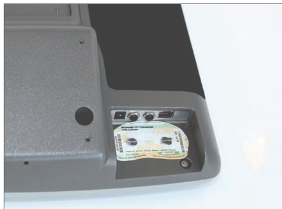
Bild 7: Ström, brytare, LAN kontakter och Windows licensmärkning
