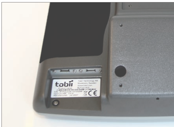
Bild 6: USB anslutningar och Tobii's serienummer
