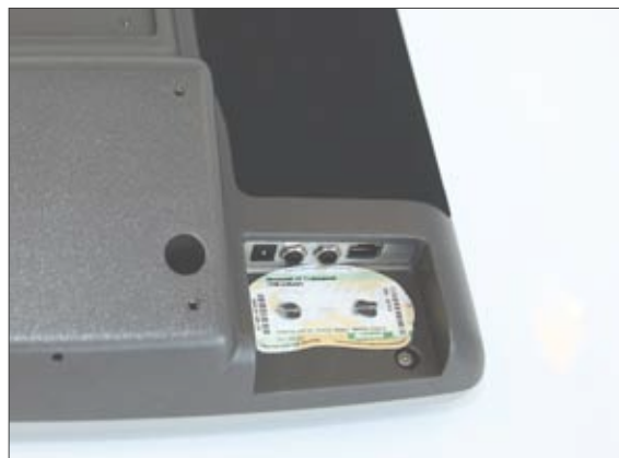
Figur 7: Strøm, bryter, LAN tilkobling og Windows lisensmerke
