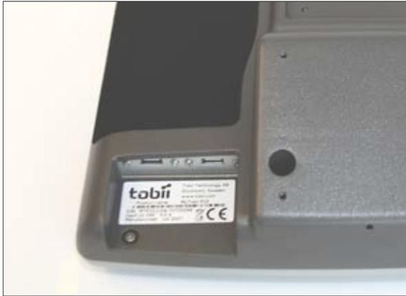
**Abbildung 6:** USB-Anschlüsse und Aufkleber mit Tobii-Seriennummer
