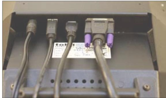
**Abbildung 10:** Von links nach rechts: Strom-, USB-, Firewire- und Monitorkabel
