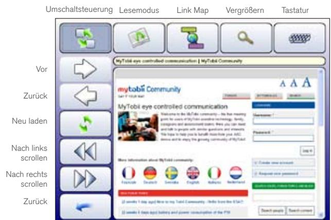
**Abbildung 81:** Webbrowser mit aktivierter Umschaltsteuerung
