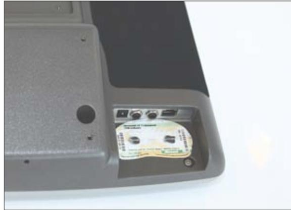
**Abbildung 7:** Stromanschluss, Taster, LAN-Anschlüsse und Windows-Lizenz aufkleber
