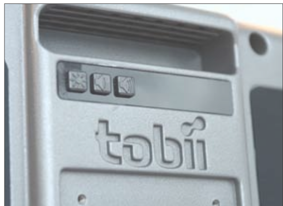
Figur 9: Knapper til justering af lydstyrke og kontrast.
