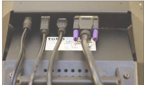
Figur 10: Fra venstre mod højre: Strøm, USB, Firewire og monitor kabel.
