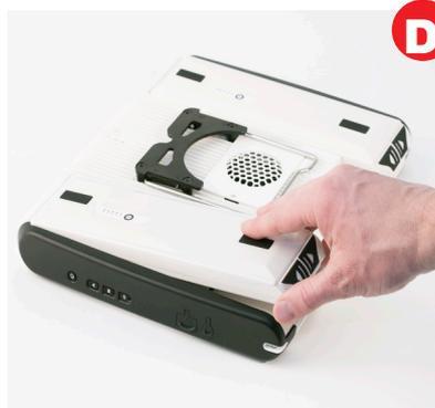
Installare le batterie e controllare il livello di carica.
